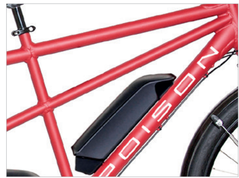
Spezielle Gussets stabilisieren den Rahmen an wichtigen Punkten.
