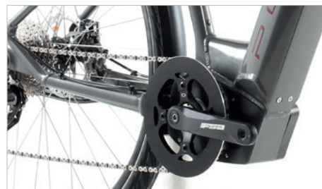
Der kraftvolle Brose Motor bildet den zentralen Schwerpunkt des Rades.
