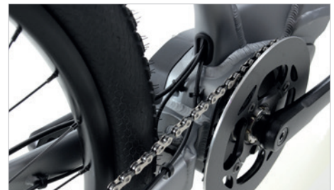
Alle Kabel und Züge werden sauber und geschützt durch den Rahmen geführt.
