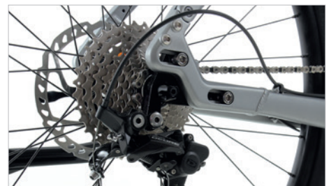
Verschiebbare Ausfallenden für die perfekte Spannung von Kette oder Gates Riemen.
