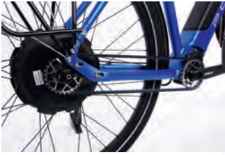
Nahezu wartungsfrei: NeoDrives-Pinion-Gates-Kombination.
