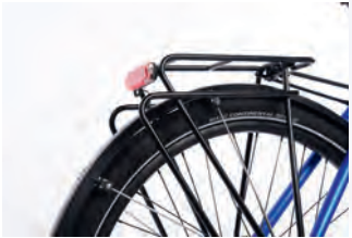
Sehr variabel: Der Tubus-Gepäckträger schultert 26 Kilogramm.
