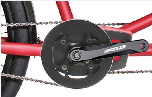
Die Brose Motoren passen millimetergenau in den eigens entwickelten Tandem-Rahmen.
