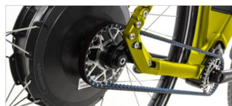
Die große Bandbreite (636 %) des Pinion-Getriebes, kombiniert mit dem kraftvollen Heckmotor, bezwingt jeden Anstieg.
