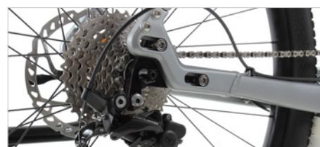
Verschiebbare Ausfallenden für die perfekte Spannung von Kette oder Gates Riemen.
