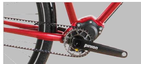
Der passgenau gearbeitete Rahmen nimmt C1.12, P1.9XR, P1.12 sowie P1.18 Getriebe auf.
