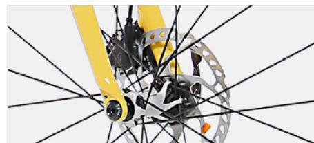
Sicher ist sicher: Scheibenbremsen und Steckachsen in Gabel und Hinterbau.
