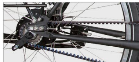
Über die horizontalen Ausfallenden kann der Gates Riemen millimetergenau gespannt werden.
