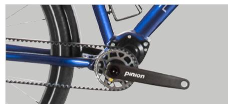
Die Kombination von Pinion Getriebe und Gates Riemen garantiert dauerhaften Fahrspaß auch bei extremer Beanspruchung.
