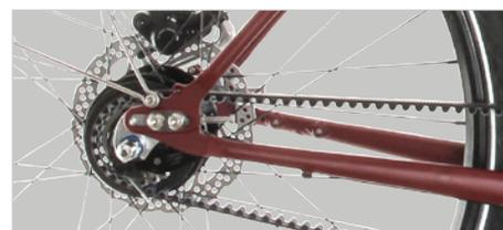
Optimale Energieübertragung durch millimetergenaue Justage des Gates Riemens über horizontale Ausfallenden.
