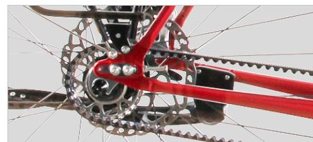
Durch horizontale Ausfallenden kann der Gates Riemen perfekt für jeden Fahrer und jede Reise gespannt werden. Dadurch wird unnötiger Energieverlust vermieden.
