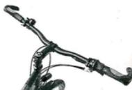
720 mm pure Kontrolle: Der breite Lenker am Poison ist der breiteste im Testfeld.
