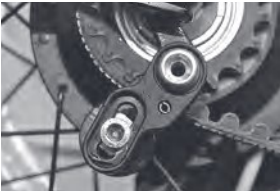
Abbildung 3: Seitenansicht des montierten Snubbers
