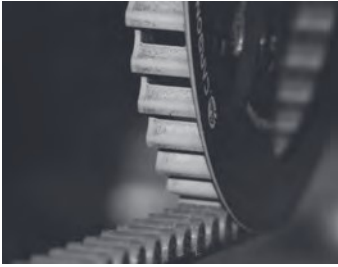
Abbildung 2: Abnutzung der produktionstechnisch bedingten blauen Schicht
