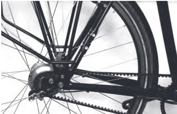
Abbildung 3: Beispiel zur Rahmenkonstruktion: Teilung der Sitzstrebe
