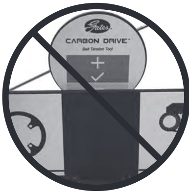
Abbildung 2: Zu hohe Riemen­spannung
