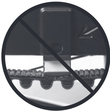
Abbildung 1: Falsche Riemen Spannung
