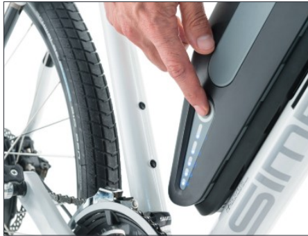
Externer Akku: Akkutaste betätigen. Position der Akkutaste kann variieren.
