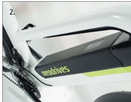
Semiintegrierter Akku mit Akkutaste: Akkutaste betätigen nicht nötig
