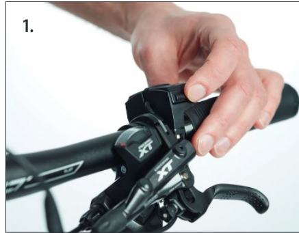
Einschalten des Akkus über die Ein-/Aus-Taste des Systems. Der Bildschirm benötigt wenige Sekunden und zeigt dann den Startbildschirm an.
