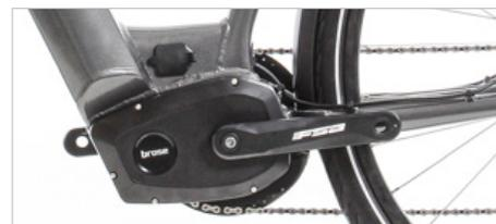
Die Brose Motoren fügen sich exakt in den eigens entwickelten Rahmen.
