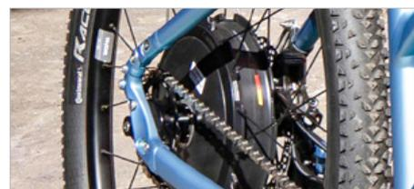
Kraftvolles Fahrverhalten durch direkt im Hinterrad verbauten großvolumigen Neodrives Motor
