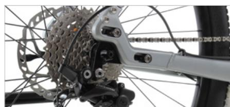
Verschiebbare Ausfallenden für die perfekte Spannung von Kette oder Gates Riemen.
