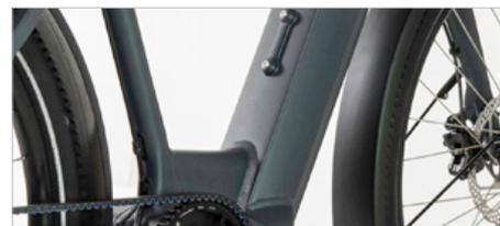
Der Akku wird in dem Unterrohr versteckt und die Öffnung nur von unten sichtbar.
