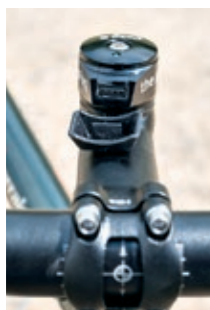
Highlights: Beim Silkroad machen Kleinigkeiten den Unterschied, wie die USB-Buchse am Lenker und der Anschlagbegrenzer am Steuerrohr
