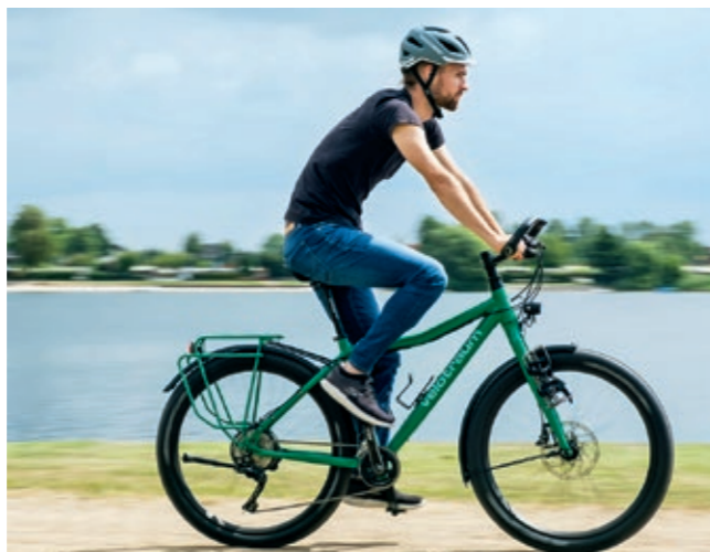
Die Ausstattung unseres Testbikes beinhaltet Gepäckhalter an der Federgabel, an denen sich große Flaschen oder ähnliche Gegenstände festzurren lassen. Für breite Reifen ist genug Platz im Rahmen
