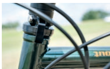
Highlights: Beim Silkroad machen Kleinigkeiten den Unterschied, wie die USB-Buchse am Lenker und der Anschlagbegrenzer am Steuerrohr
