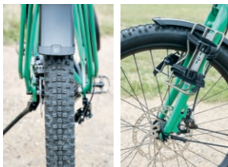
Die Ausstattung unseres Testbikes beinhaltet Gepäckhalter an der Federgabel, an denen sich große Flaschen oder ähnliche Gegenstände festzurren lassen. Für breite Reifen ist genug Platz im Rahmen
