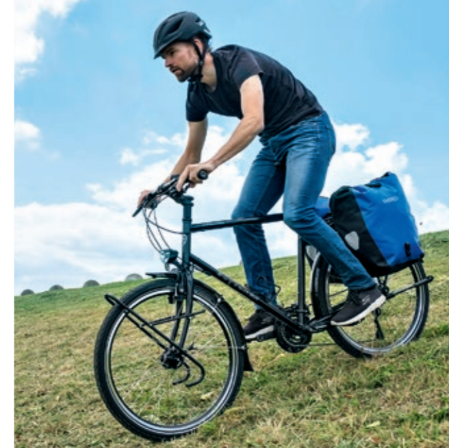
Geländetauglich. Mit verstellbarem Vorbau und hohen Spacern kann viel variiert werden, der Käfig hinten schützt das Deore-XT-Schaltwerk
