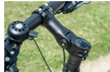
Geländetauglich. Mit verstellbarem Vorbau und hohen Spacern kann viel variiert werden, der Käfig hinten schützt das Deore-XT-Schaltwerk
