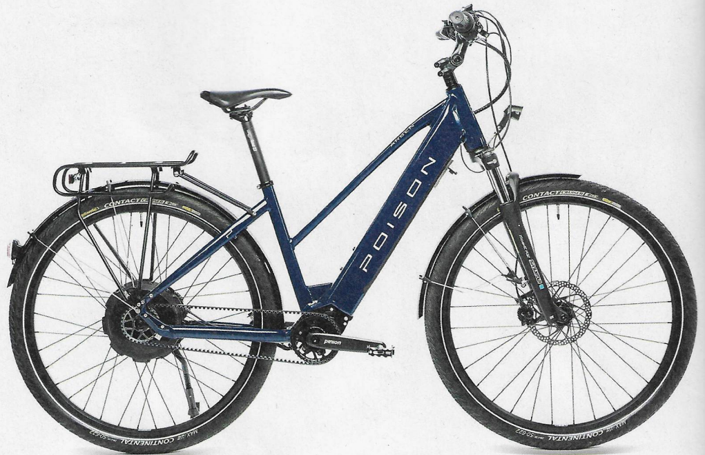
Starke 600% Gesamtübersetzung: Pinions Tretlagergetriebe P1.12.
