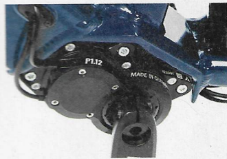
Starke 600% Gesamtübersetzung: Pinions Tretlagergetriebe P1.12.
