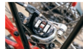
Alte Schule: Dreifach-Antrieb (oben), mechanische Bremsen
