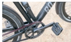
Rose kombiniert beim Antrieb Riemen und Rohloff-Nabe
