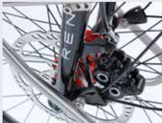
Magura-4-Kolben-Bremse am Rennstahl: Bremskräfte, Abrieb und Wärmeentwicklung verteilen sich auf die doppelte Fläche. Top in Bedienungskomfort, Sicherheit und Verschleiß!
