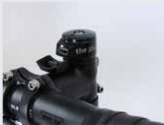
USB-Lader an Tout Terrain und Rennstahl: Navi, Kamera, Handy – der Nabendynamo produziert genug Strom für tragbare Geräte, der kann hier einfach abgezapft werden
