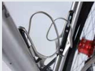
Flaschenhalter am Poison: Schön und sinnvoll, die Elite Halter passen optisch zum Rahmen, außerdem übersteht Titan die ständigen Bewegungen der Flaschen schadlos.
