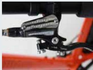
Hope-Bremshebel am Idworx: Top Bremsanlage mit einstellbaren „Anschlägen“ am kurzen Bremshebel, kann so auf Handgröße und individuelles Bremsverhalten angepasst werden.
