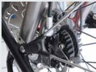
XT mit Kühlrippen am Poison: Die Shimano-Bremse soll früher schnell heiß gelaufen sein inklusive Bremskraftverlust. Das konnten wir zumindest im Mittelgebirge null bestätigen.
