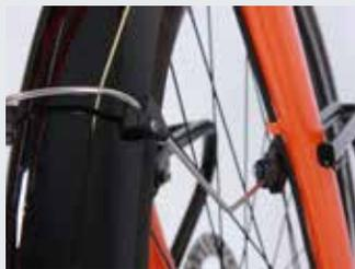
Schutzblech am Idworx: Beispiel für Top-Montage, das Schutzblech greift am Lowrider, die kurzen Streben verbiegen weniger leicht. Ideal sind sieben Haltepunkte der Bleche am Rahmen.
