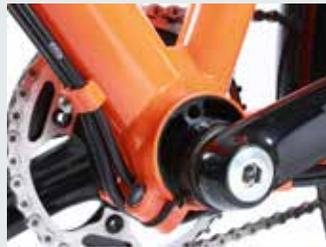
Züge am Idworx: Züge sind am Unterrohr gut aufgehoben, wenn sie komplett gedichtet und perfekt verlegt sind wie hier. Die Sockel dienen als Zusatzmounts für Flaschen.
