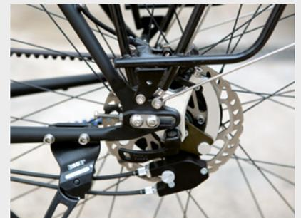
Auch Poison setzt auf verschiebbare Ausfallenden. Darunter befindet sich die externe Rohloff-Schaltansteuerung.
