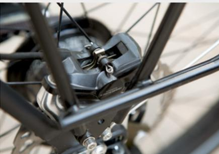
Verzögert wird beim Morphin mit hydraulischen Scheibenbremsen von Shimano, die wenig Wartung benötigen und Top-Wirkung haben.
