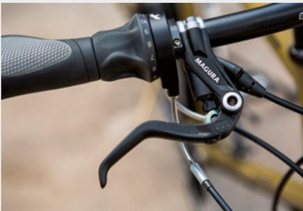
Die Kombination aus Ergon-Griff, Twist Shift und Magura-Hebel sorgt für hohen Bedien- und Reisekomfort.
