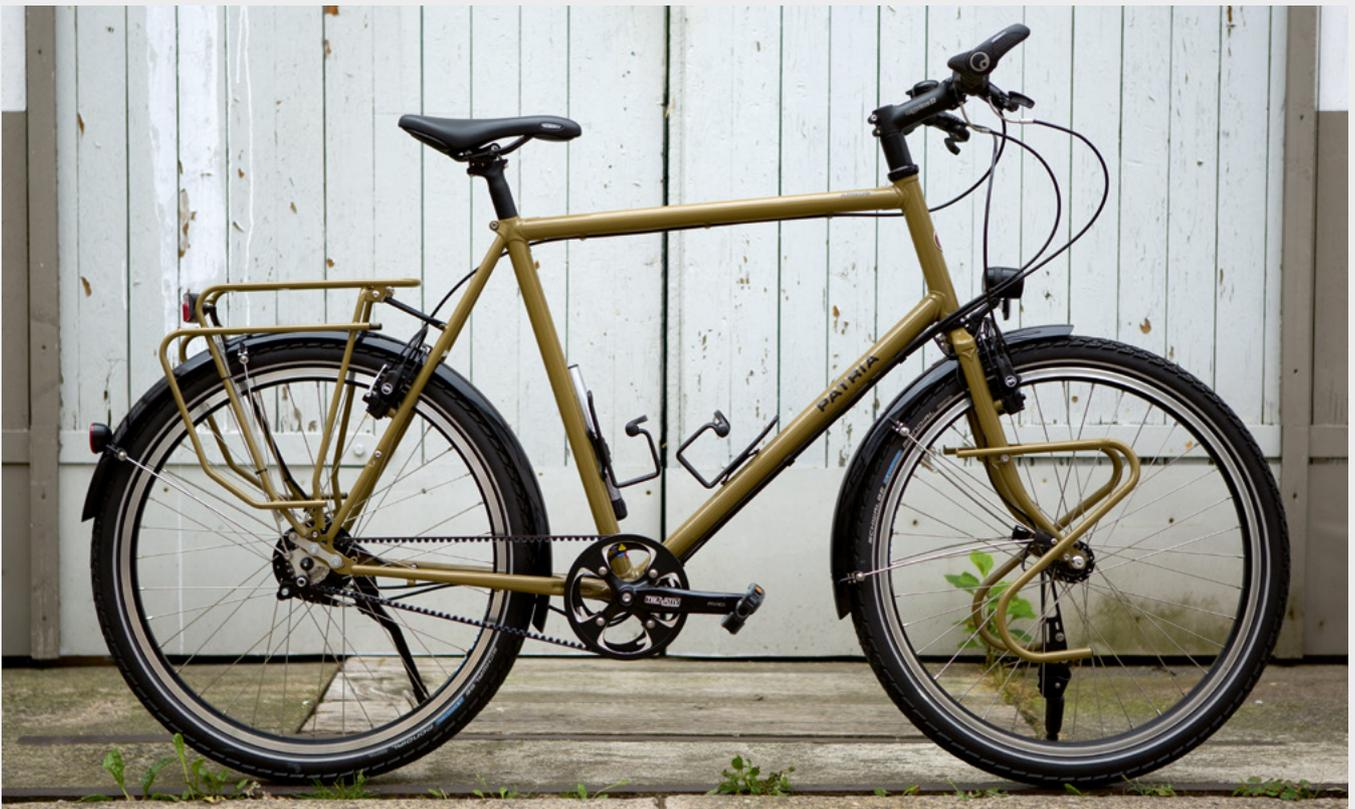
Klassischer Look: Der gemuffte Stahlrahmen mit fast geradem Oberrohr ist eine Augenweide und sorgt für eine leicht gestreckte Sitzposition.
