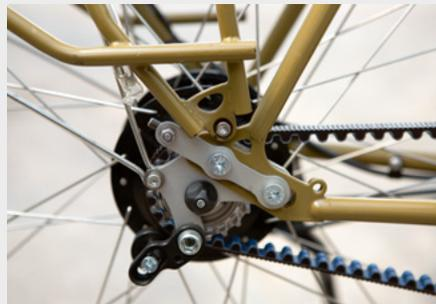
Mittels verschiebbarer Ausfallenden wird der Riemen gespannt – eine gute Alternative zu exzentrischen Tretlagern.
