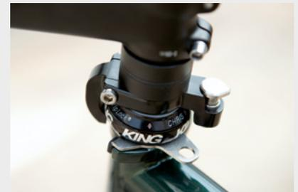
Die mechanische Lenkerfixierung samt Lenkschlag ist ein gut umgesetztes und sehr praktisches Bauteil.
