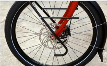
Die vordere Brems Scheibe ist mit über 200 Millimeter Durchmesser sehr üppig dimensioniert.
