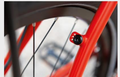
Der Rahmen verfügt über Aufnahmen für Felgenbremsen. Unser Testrad ist mit hydraulischen Scheibenbremsen bestückt.
