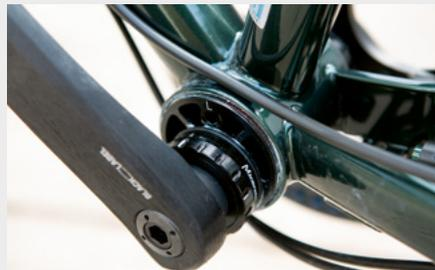
Über das exzentrische Tretlager wird der Riemen gespannt. Die Schweißnähte sind kaum erkennbar.
